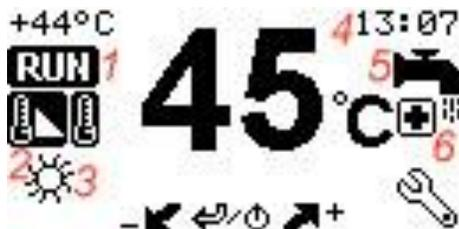
Символ RUN (1) указывает, что тепловой насос работает в активном режиме. Если же он выполняет процедуру остановки по расписанию, или остановлен внешним сигналом, например контроллером системы автоматизации, на этом месте будет отображаться STOP.
