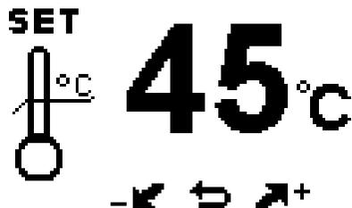
Установка желаемой температуры производится вращением ручки управления. Подтверждение и выход на основной экран – коротким нажатием.
