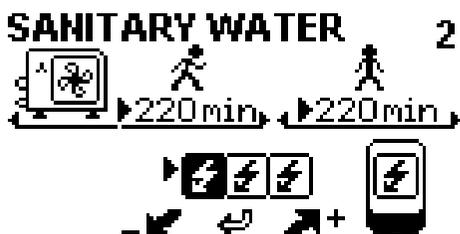
На второй вкладке настраивается максимальное время, в течение которого тепловой насос будет нагревать ГВС (подпункт отмечен символом идущего человека). Если же заданная температура будет достигнута раньше, то гидромодуль перейдет в основной режим (обогрев/охлаждение).
