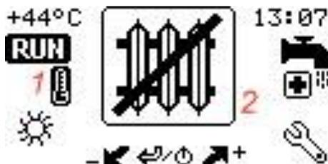
При использовании гидромодуля только для приготовления ГВС, на основном экране отображается символ (2).
