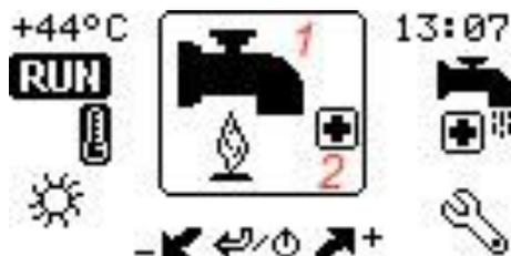
Если на основном экране отображается символ (1), это указывает на то, что непосредственно в данный момент идет приготовление ГВС. Если одновременно с этим символом отображается знак (2), то в данный момент ведется обеззараживание бака ГВС.
