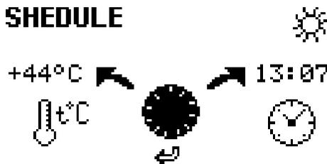
При программировании события вращением ручки управления против часовой стрелки, устанавливается целевая температура или настраивается выключение теплового насоса. Вращением ручки по часовой стрелке устанавливается время, когда это произойдет.
