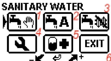
(1) - Однократный ручной запуск приготовления ГВС. При подтверждении коротким нажатием на ручку управления, иконка активируется и меняет цвет фона на черный. Тепловой насос перейдет к немедленной подготовке ГВС, согласно параметрам, заложенным в подразделе настроек ГВС.
