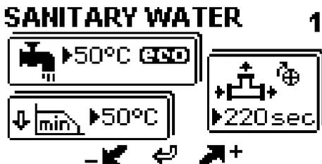
В первой закладке настраивается температура ГВС  $+40^{\circ}\text{C} \dots +60^{\circ}\text{C}$  и максимальное падение температуры воды в баке  $\Delta 5^{\circ}\text{C} \dots \Delta 30^{\circ}\text{C}$  от заданной температуры. Этот параметр определяет, насколько должна упасть температура воды в баке, чтобы тепловой насос начал ее нагревать. И также выставляется время открытия/закрытия электронного клапана,
