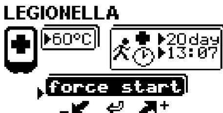
После принудительного включения режима, когда процесс будет завершен, система автоматически перейдет в режим стандартной активации через настроенный период.
