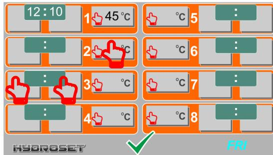
Попадаем в поле событий. Запрограммированное событие будет отображаться со временем его начала и целевой температурой теплоносителя.
